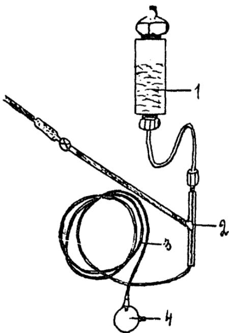
Рис. 2. Схема динамического диффузионного дозатора.
