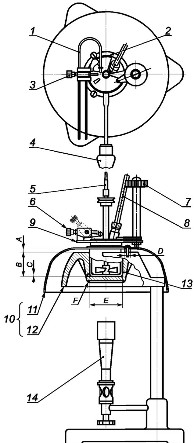
Рисунок А1.1 — Аппарат Пенки-Мартенса с закрытым тиглем
