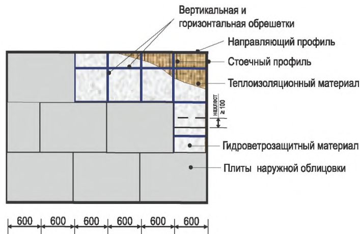
Рис. 13. Крепление наружной облицовки к каркасу
