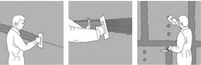
Рис. 17. Шпаклевание стыков и мест установки шурупов.
