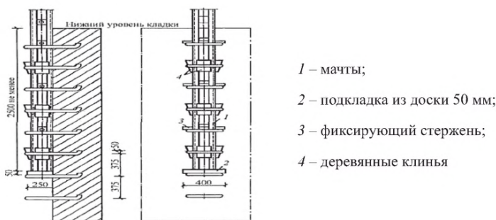
Рисунок 13 – Крепление мачты крана-укосины в скобах
