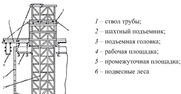
Рисунок 26 – Установка шахтного подъемника, площадок и подвесных лесов
