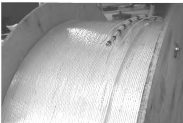
Рисунок 16 — Схема укладки кабелей на барабане
