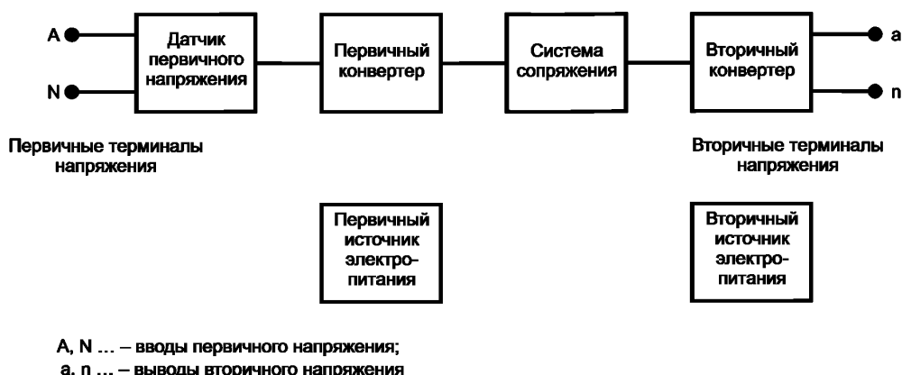
Рисунок 1 — Блок-схема заземляемого однофазного ЭТН
