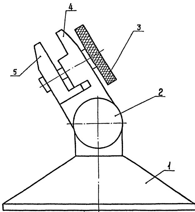
1 - основание, 2 - винт, 3 - гайка, 4 - неподвижная губка,
