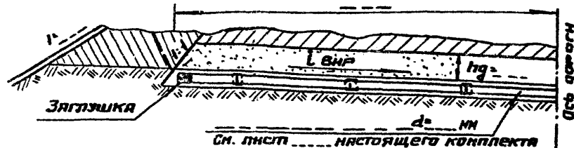
Поперечная прорезь на вираже при продольном уклоне свыше 40‰
