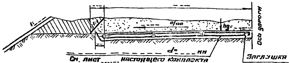
Поперечная прорезь при продольном уклоне свыше 40‰
