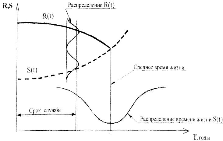
Графики для принципиального определения изменения во времени функции, характеризующей способность конструкции сопротивляться воздействию ( $R(t)$ ) и функции воздействия ( $S(t)$ ) с учетом вероятностной оценки их значений
