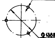
Разметка отверстий для крепления высокочастотного заградителя 30мб. Ф20
