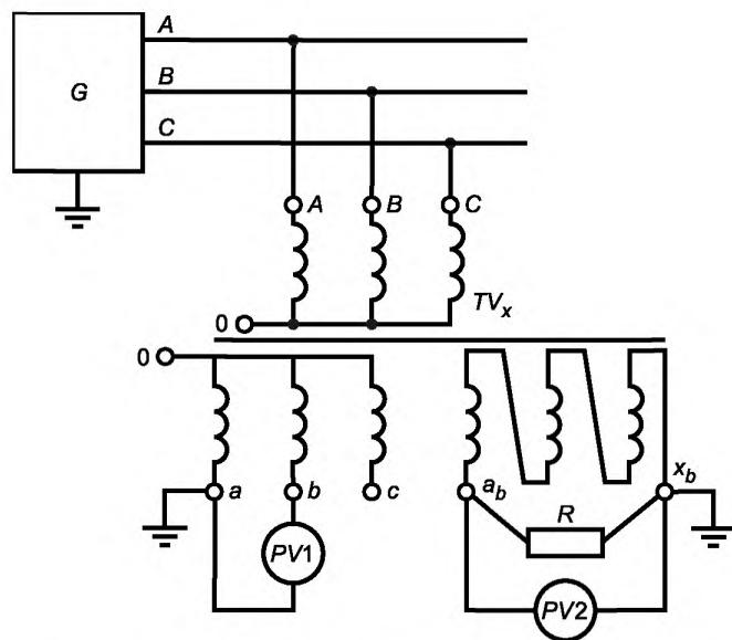
$TV_x$  — поверяемый трансформатор;  $G$  — источник трехфазной системы напряжений;
