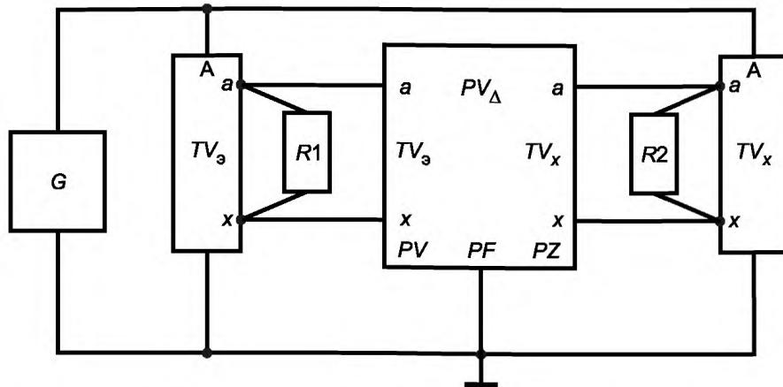
$G$  — источник высокого напряжения;  $TV_0$  — эталонный трансформатор;  $R1$  — нагрузочное устройство эталонного трансформатора;  $TV_x$  — поверяемый трансформатор;  $R2$  — нагрузочное устройство поверяемого трансформатора;  $PV_\Delta$  — прибор сравнения;  $PV$  — функция измерения входного напряжения;  $PF$  — функция измерения частоты входного напряжения;  $PZ$  — функция измерения нелинейных искажений
