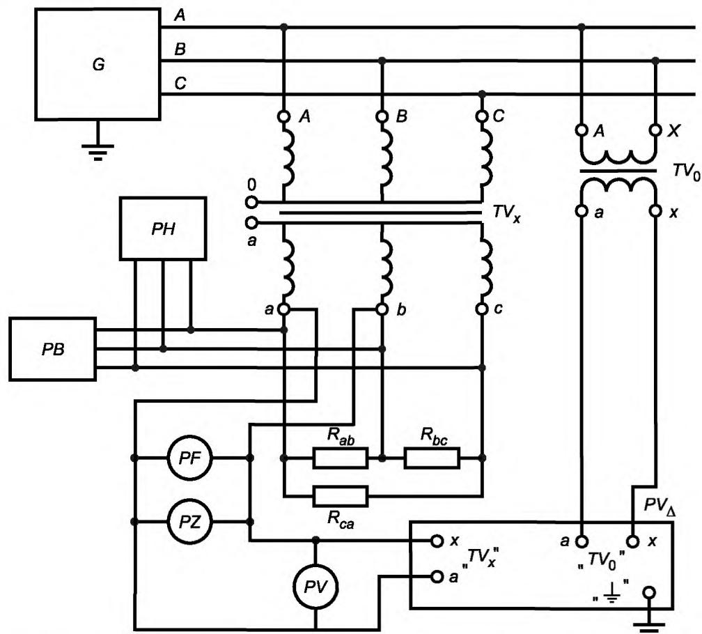
*G* — источник трехфазной системы напряжений;  $TV_x$  — поверяемый трансформатор;  $TV_0$  — эталонный трансформатор;  $PH$  — фазоуказатель;  $PB$  — измеритель несимметрии;  $PZ$  — измеритель нелинейных искажений;  $PF$  — частотомер;  $PV$  — вольтметр с пределом измерения 150 В (подключается в случае отсутствия встроенного вольтметра в приборе сравнения);  $R_{ab}$ ,  $R_{bc}$ ,  $R_{ca}$  — нагрузочные устройства поверяемого трансформатора;  $PV_\Delta$  — прибор сравнения
