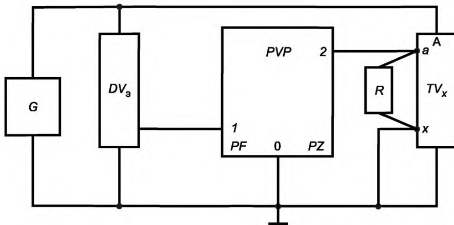
$G$  — источник высокого напряжения;  $DV_3$  — эталонный делитель;  $R$  — нагрузочное устройство поверяемого трансформатора;  $TV_x$  — поверяемый трансформатор;  $PVP$  — вольтфазометр;  $PF$  — функция измерения частоты входного напряжения;  $PZ$  — функция измерения нелинейных искажений
