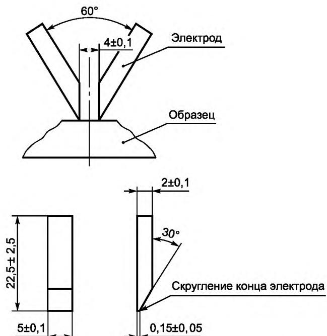
Рисунок 9 — Расположение и размеры электродов для испытания на трекингстойкость
