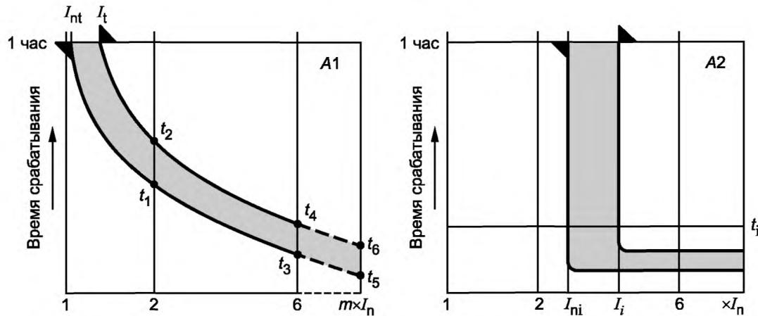
Рисунок А.1 — Характеристика только тепловой защиты
