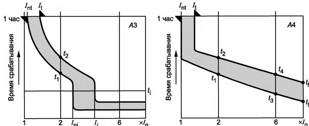
Рисунок А.3 — Характеристика тепловой и электромагнитной защиты
