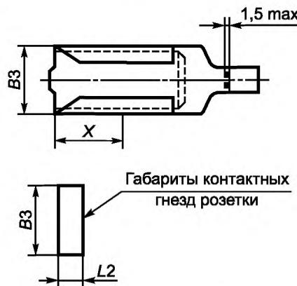
П р и м е ч а н и е 1 — Для определения размеров гнездового наконечника размеры  $B_3$  и  $L_2$  необходимо согласовать с размерами штыревого наконечника для гарантии обеспечения надежного соединения в наихудших условиях (а также размеры элементов фиксации при их наличии).
