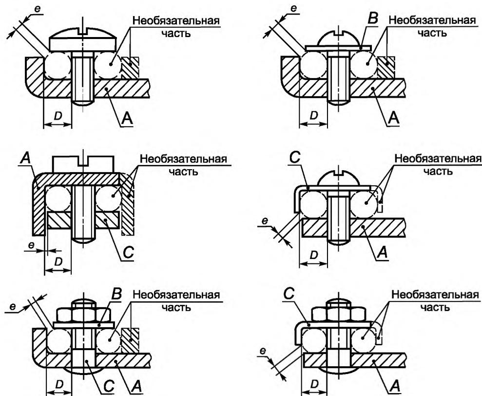
A — фиксирующая часть; B — шайба или прижимная пластина;
