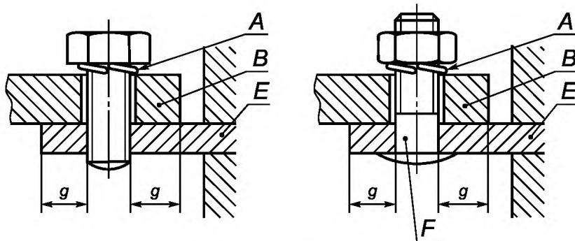
А — устройство против самоотвинчивания; В — кабельный наконечник или шина;
