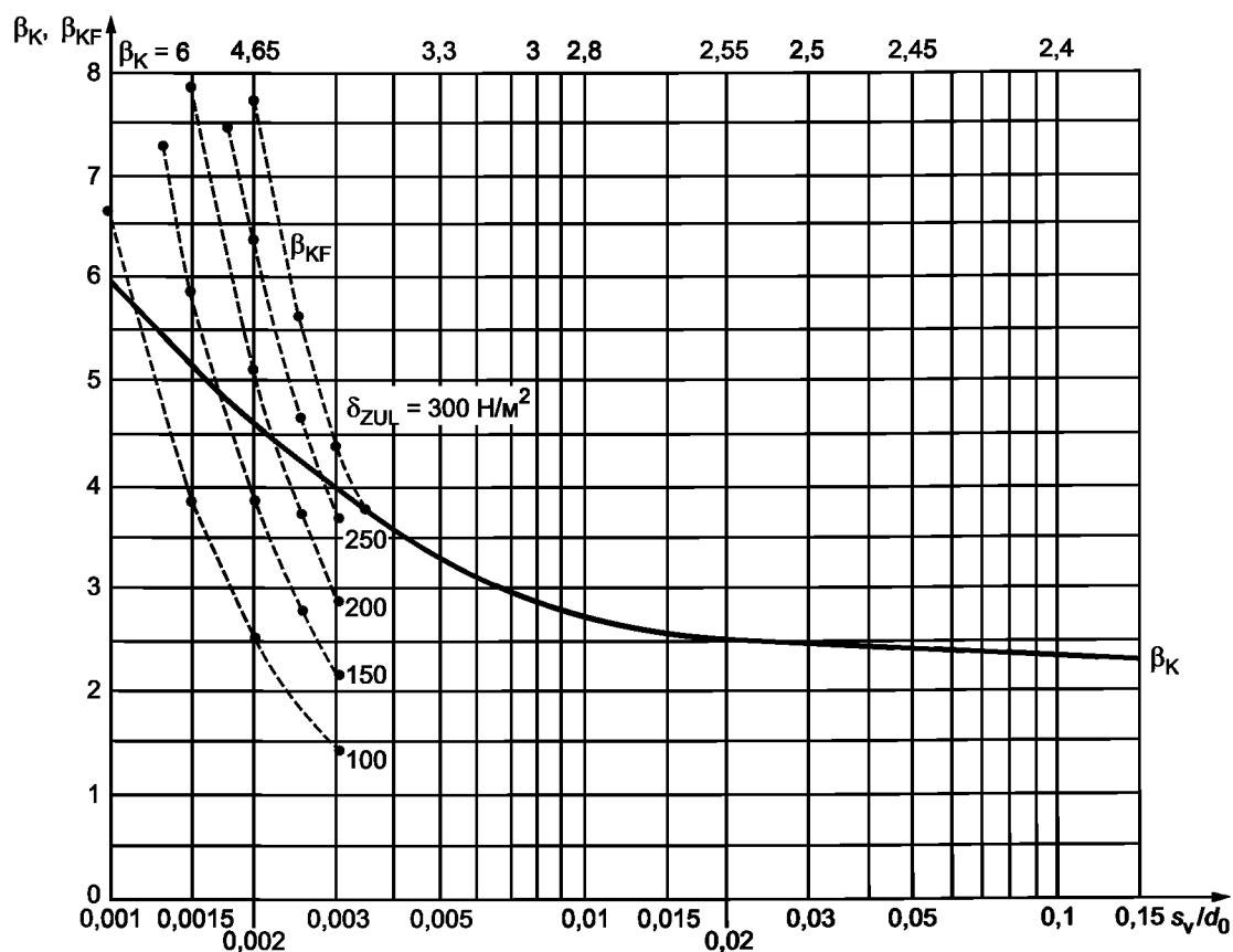
Рисунок В.17 — Значения коэффициентов формы  $\beta_K$  и  $\beta_{KF}$  для коробовых днищ
