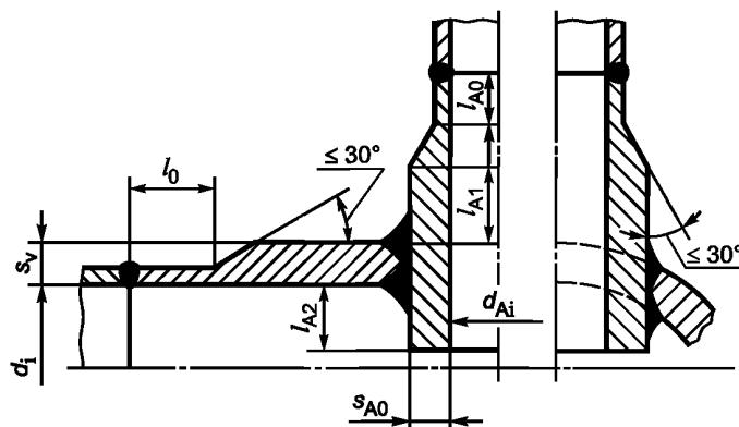
Рисунок А.2 — Усиление посредством вваренного патрубка с полным проплавлением
