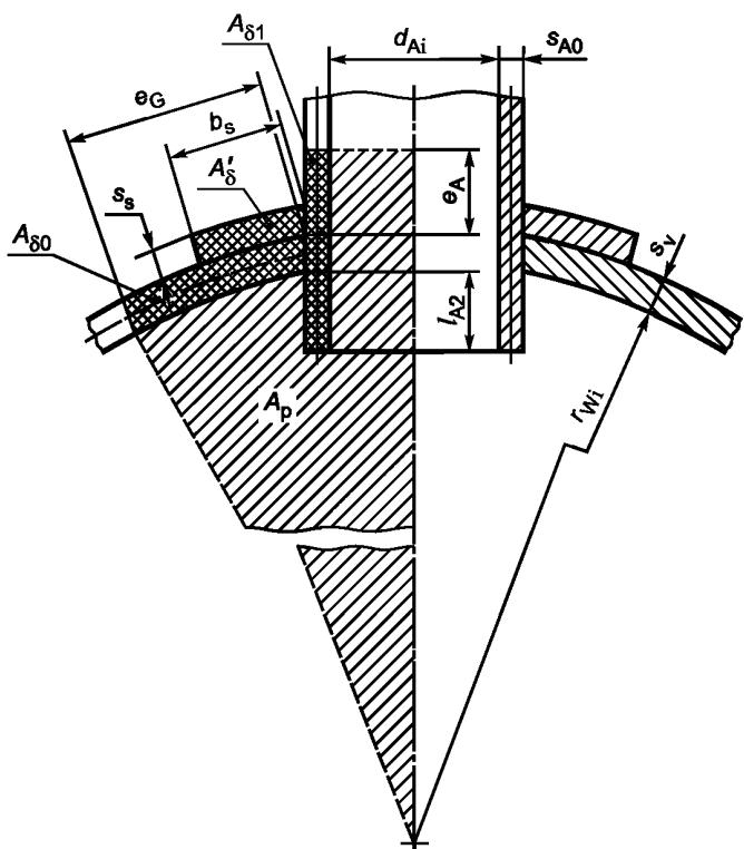
$A_p$  — площадь, нагружаемая давлением для каждого элемента;  $A_\sigma$  — полезная площадь поперечного сечения каждого элемента;  $s_v$  — толщина стенки основной оболочки с отверстием
