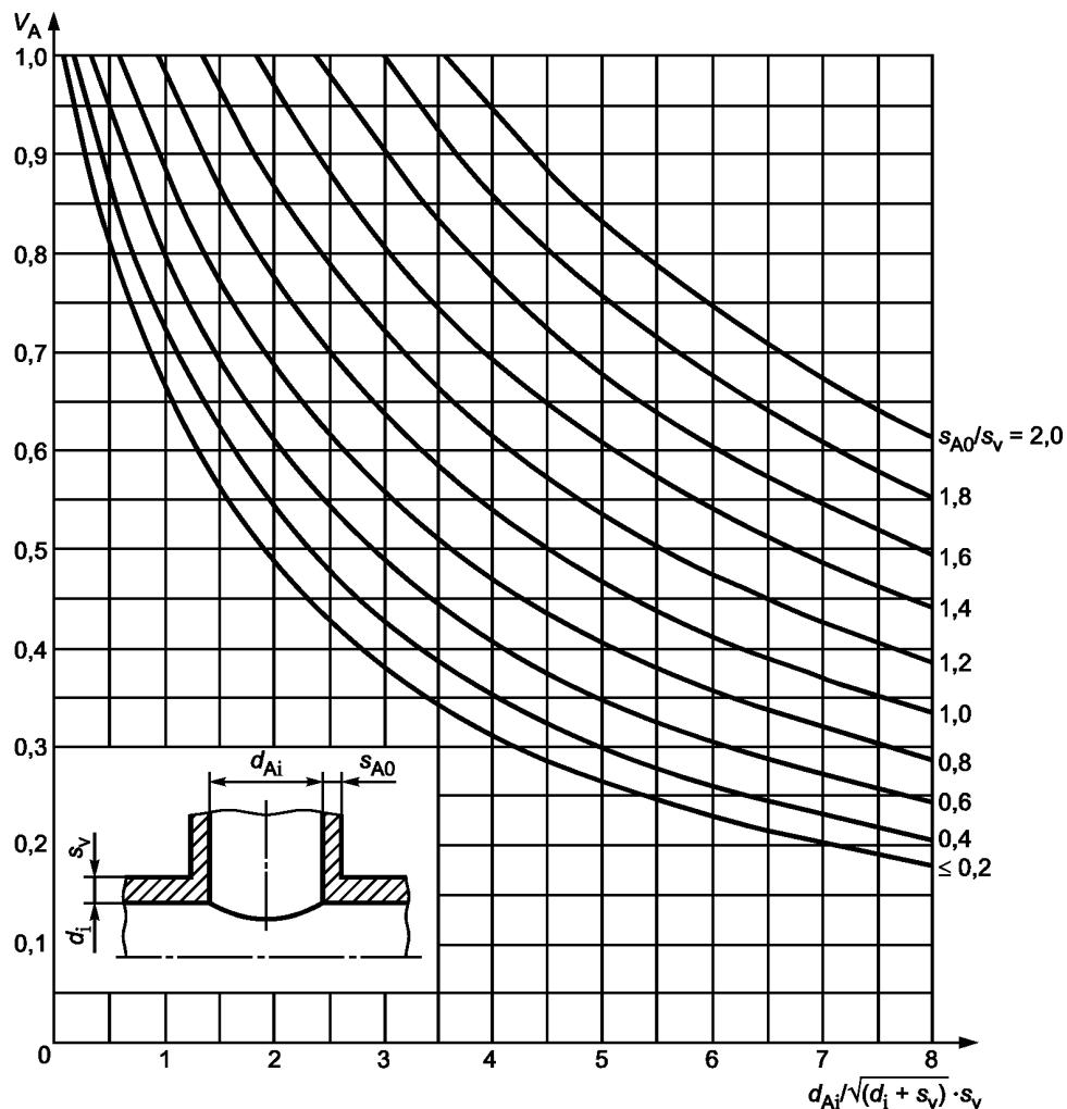
Рисунок А.20 — Значения коэффициента эффективности  $V_A$  для цилиндрических оболочек с вертикальным патрубком, используемого для проверки правильности расчета готовых конструкций ( $s_v/d_i \leq 0,05$ )
