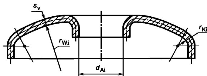
Рисунок В.3 — Выпуклое днище с отбортированным (загнутым внутрь) фланцем, снабженное люком
