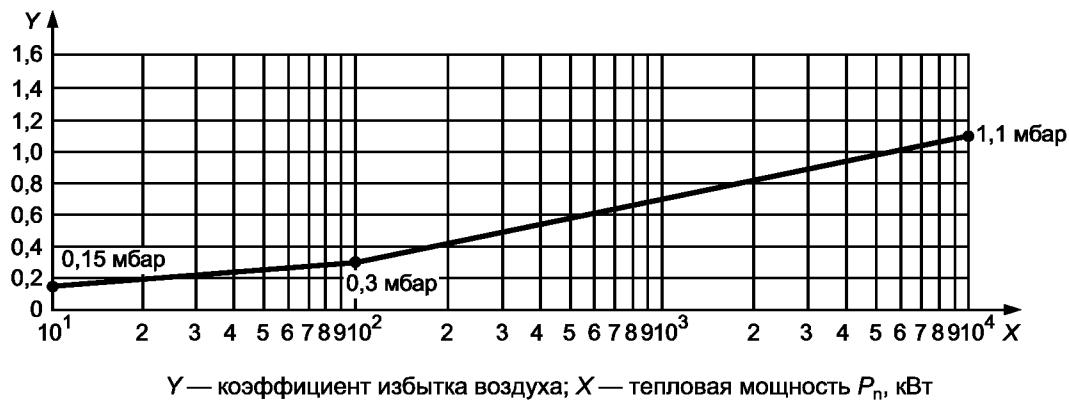
Рисунок 4 — Разрежение за котлом на естественной тяге (мбар)
