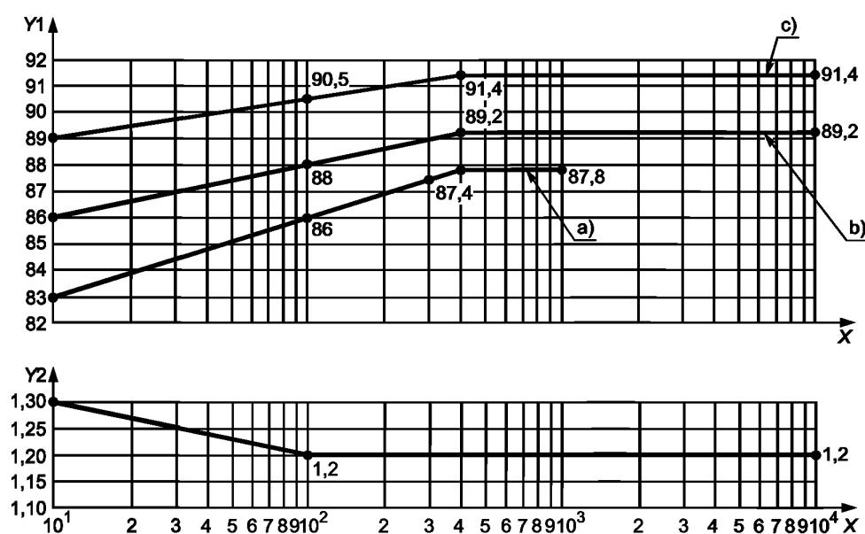
Y1 — КПД; Y2 — коэффициент избытка воздуха; X — тепловая мощность  $P_n$ , кВт <sup>a)</sup>  $\eta_{k_1}$  отопительный котел, 30 %  $P_n$ ; <sup>b)</sup>  $\eta_{k_1}$  отопительный котел,  $P_n$ ; <sup>c)</sup>  $\eta_{k_1}$  низкотемпературный отопительный котел,  $P_n$  и 30 %  $P_n$  (только для котлов мощностью до 1000 кВт)
