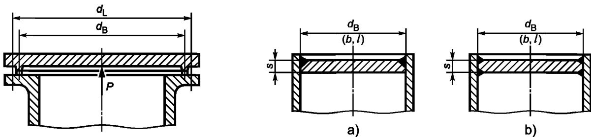
Рисунок D.4 — Прикрепленная болтами решетка с дополнительным изгибающим моментом
