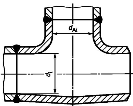
Рисунок А.4 — Усиление патрубком, приваренным к основной оболочке, выполненной выдавливанием
