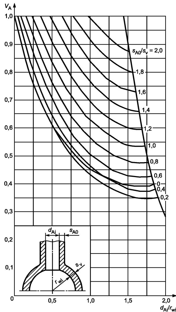
Рисунок В.14 — Значения коэффициента эффективности для сферических оболочек с вертикальным патрубком в зависимости от  $d_{Ai}/r_{wi}$  и  $s_{A0}/s_v$  при постоянном значении  $s_v/r_{wi}$
