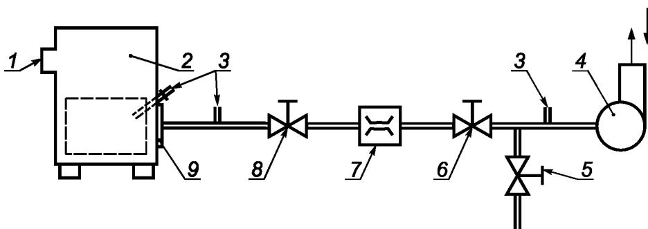
1 — газоотвод топочных газов; 2 — испытуемый котел; 3 — точки измерения давления (тяги); 4 — вентилятор; 5 — клапан 3 (перепускной); 6 — клапан 2; 7 — расходомер; 8 — клапан 1 (регулирующий); 9 — плита горелки
