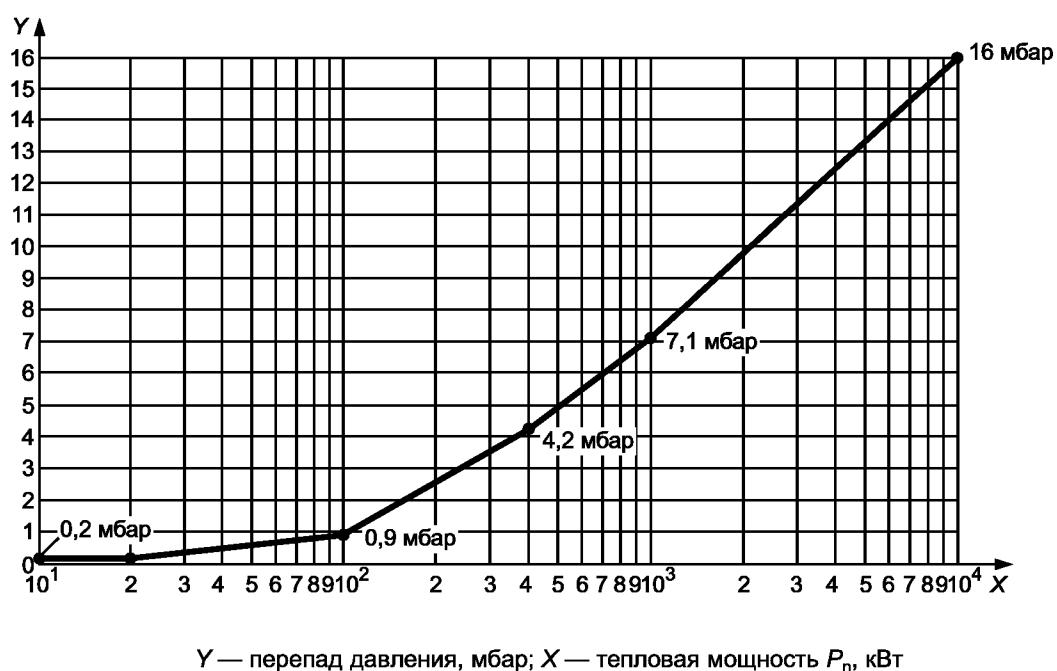
Рисунок 5 — Максимальное сопротивление газового тракта котлов под наддувом
