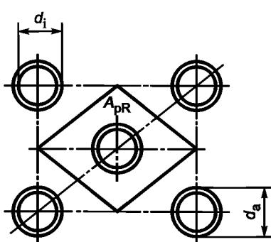
Рисунок D.15 — Площадь нагружения трубы —  $A_{pR}$
