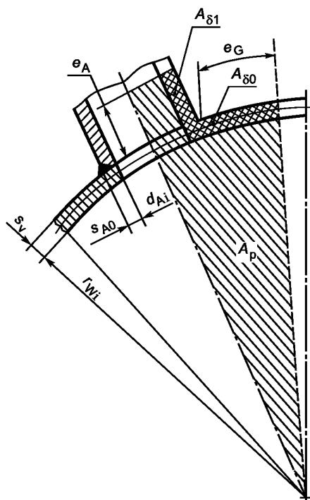
Рисунок В.6 — Схема нагружения для сферической оболочки с вертикальным патрубком
