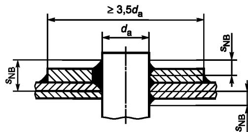
Рисунок D. 11 — Опора с приварной усилительной накладкой
