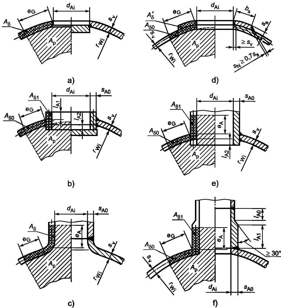
а) отверстие без усиления; б) люк с кольцом жесткости; в) отверстие, выполненное штамповкой выдавливанием; д) отверстие с упрочняющим слоем; е) отверстие с вваренным трубчатым элементом жесткости; ф) отверстие с приварным трубчатым элементом жесткости
