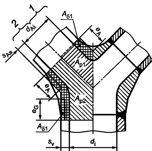
Рисунок А.16 — Схема нагружения для штампованного Y-образного патрубка с конусными переходами и угловыми швами
