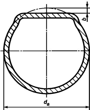
Рисунок Е.2 — Уплотнение цилиндрических оболочек
