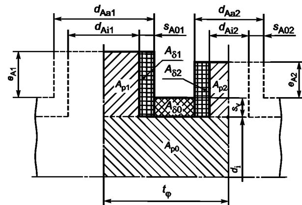
Рисунок А.11 — Смежные отверстия с различными диаметрами патрубков (для  $\varphi_A = 0$ )
