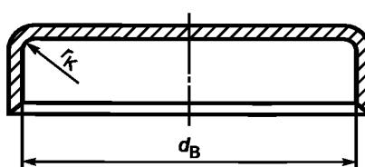
Рисунок D.2 — Круглое плоское днище с фланцем
