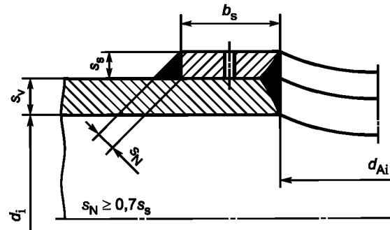
Рисунок А.7 — Отверстие с упрочняющим слоем
