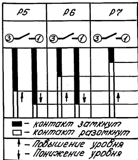
Диаграмма замыкания контактов
