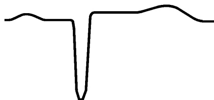
б) Форма калибровочного сигнала ЭКГ «CAL20210»
