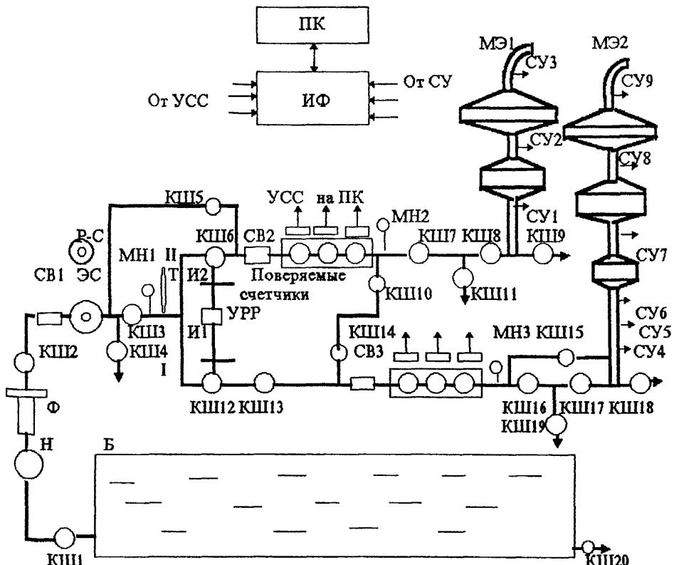
Б-бак; Н-насос; Ф-фильтр; СВ1...СВ3-струсы прямители; ЭС- эталонный расходо-мер - счетчик; Р-С - расходомер-счетчик; МН1...МН3 - манометры; Т-термометр; УПР-устройство регулирования расхода; И1,И2 - индикаторы положения шаровых кранов пульсатора расхода; УСС - узлы съема сигналов; МЭ1, МЭ2 - эталонные мерники; СУ1...СУ9 - сигнализаторы уровня; КШ1...КШ20 - шаровые краны; ПК - персональный компьютер; ИФ - интерфейс.
