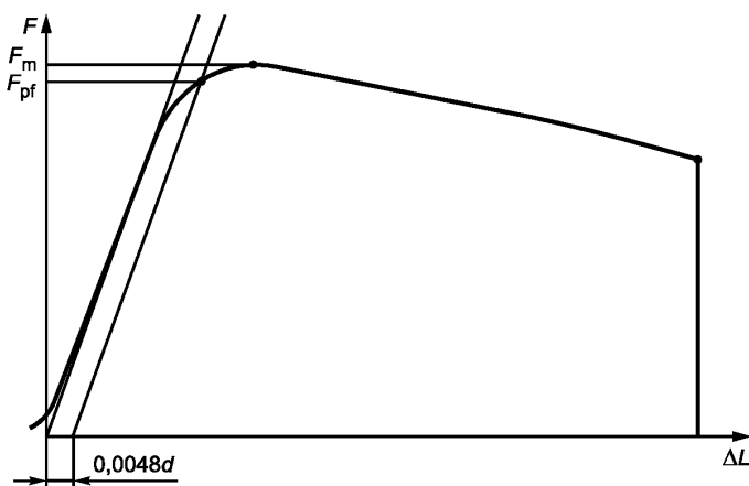
Рисунок 4 — Диаграмма нагрузка — перемещение для определения условного предела текучести R_{pf} при остаточном удлинении 0,0048d
