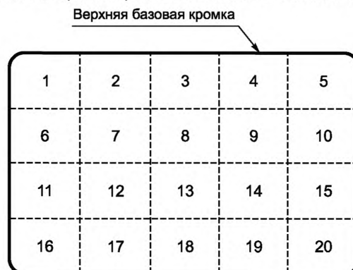
Рисунок 2 — Тестовые зоны карты для испытания на воздействие статического электричества
