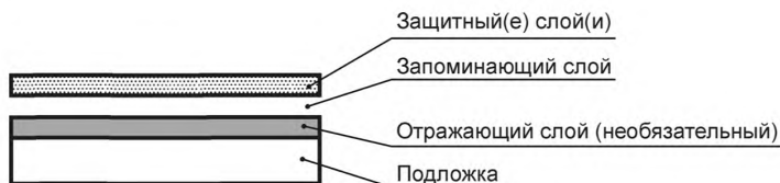
Рисунок 1 — Поперечное сечение карты с голографической памятью в оптической зоне
