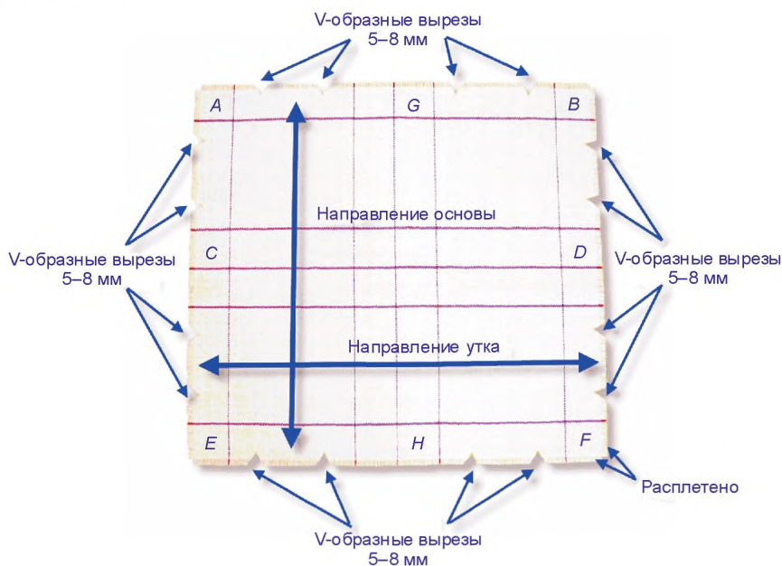
Рисунок 7 — Образец усадки шерсти, расплетенные кромки и V-образные вырезы
