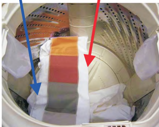
Рисунок Н.11 — Стиральные машины с вертикальной осью: расположение предметов в барабане
