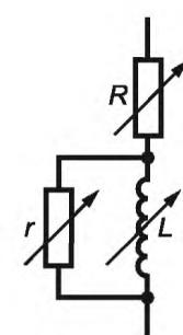
П р и м е ч а н и е — Регулируемые активные и индуктивные нагрузки  $r, R$  и  $L$  могут быть установлены на стороне высокого напряжения источника, если приемлемо.
