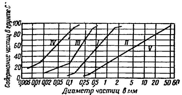
Рис. 2. Группы грунтов, используемых для намыва плотин
