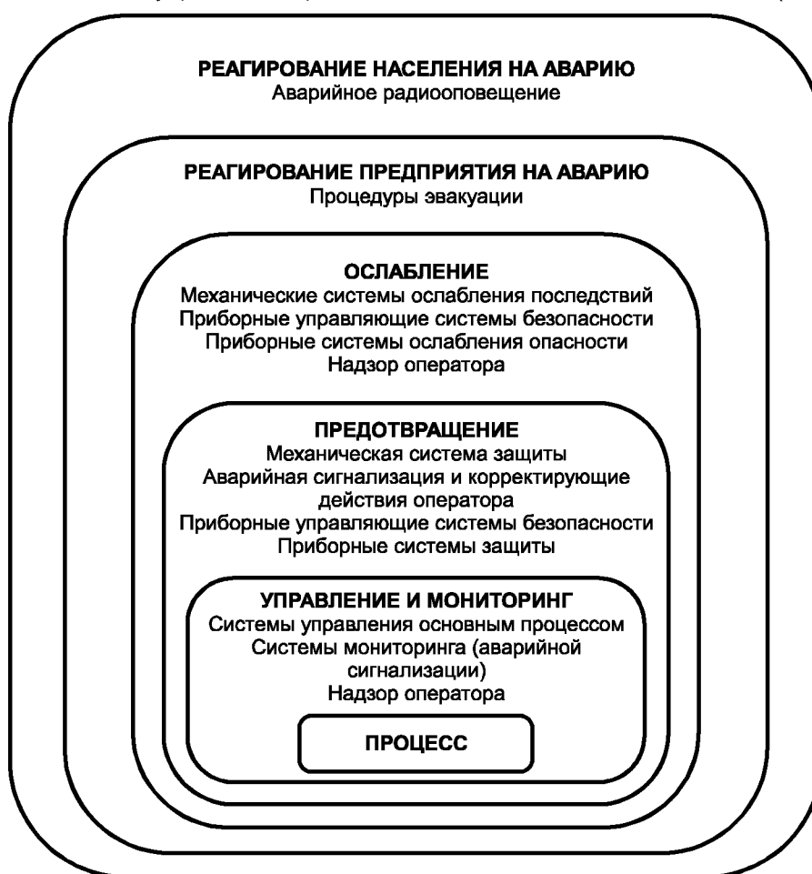
Рисунок 9 — Типовые методы снижения риска, используемые в промышленных процессах на предприятиях
