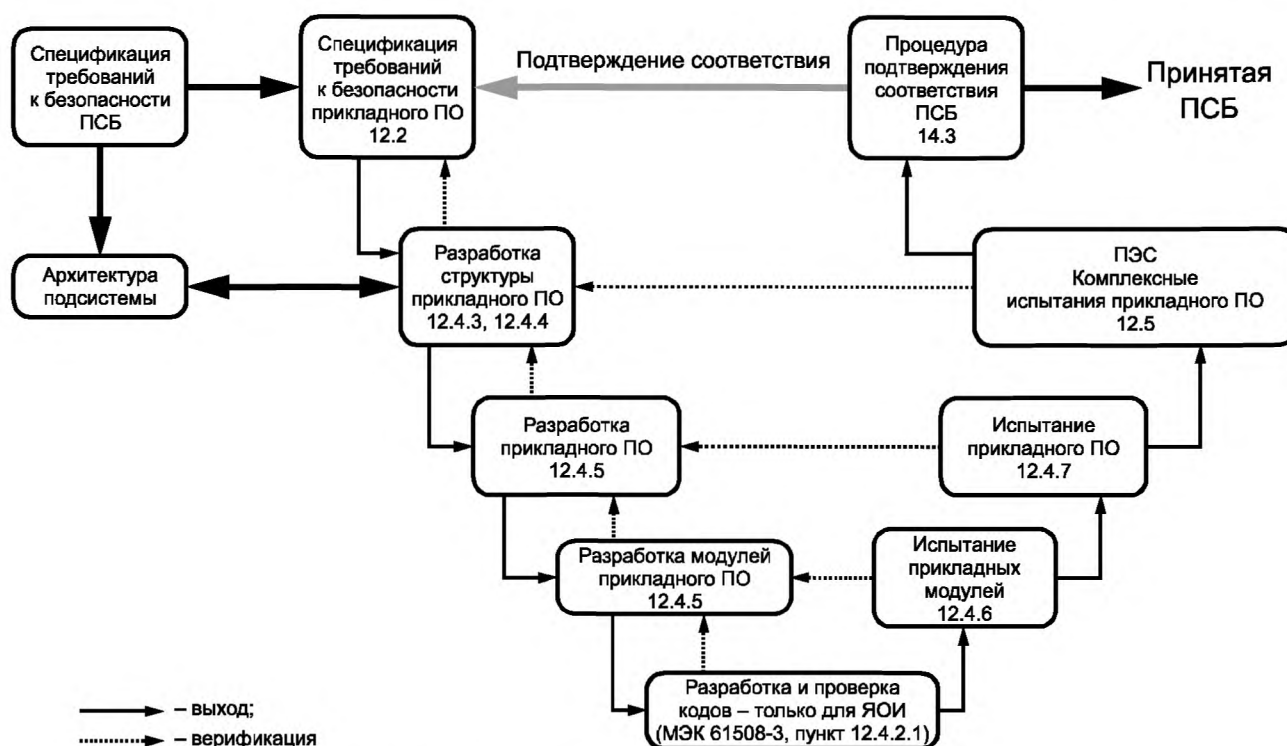
Рисунок 12 — Жизненный цикл разработки ПО (V-образная модель)
