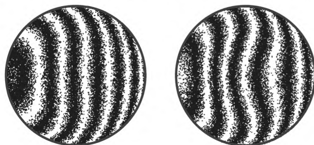
Рисунок 7 — Интерферограммы испытуемых объектов без заметных аббераций
