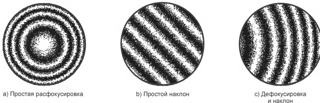
Рисунок 7 — Интерферограммы испытуемых объектов без заметных аббераций
