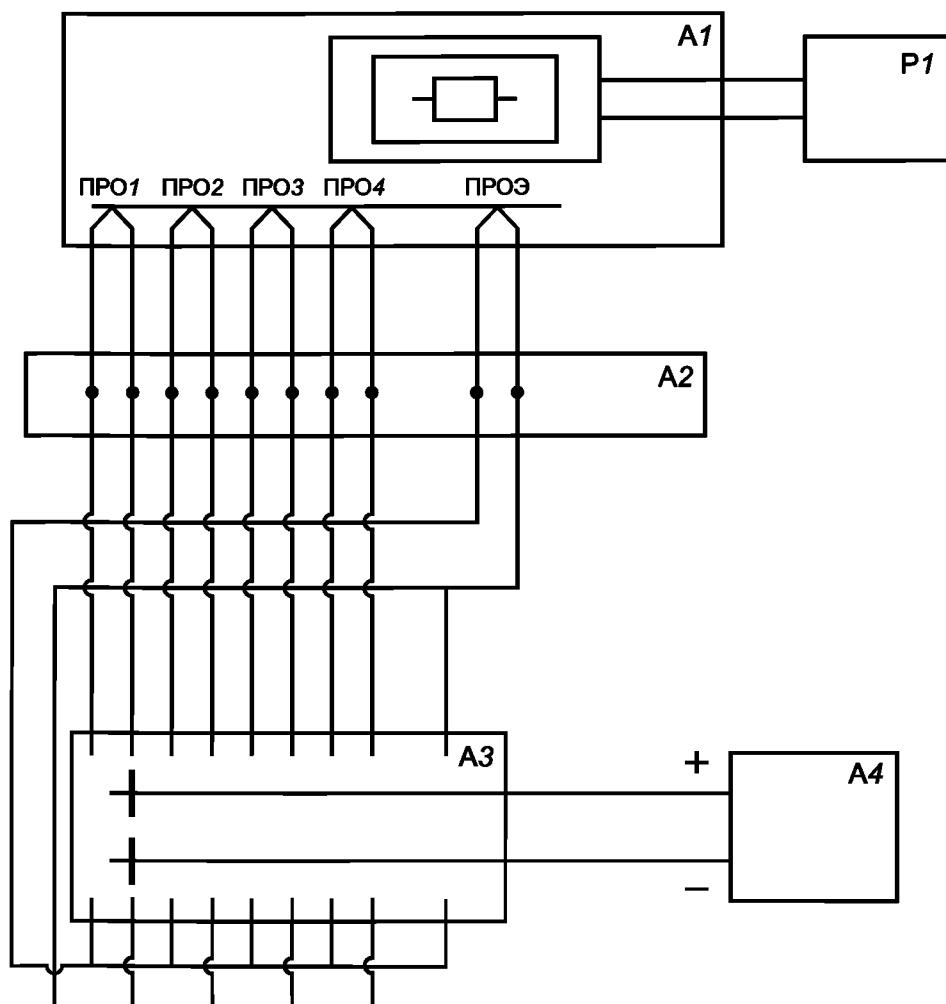
Рисунок А.1 — Электрическая схема подключения ПРО к электроизмерительному прибору
