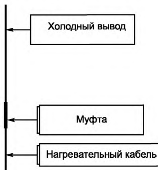
Рисунок 1 – Типовое расположение элементов при испытании муфты
