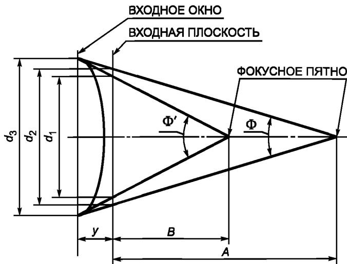
$d_1$  — РАЗМЕР РАБОЧЕГО ВХОДНОГО ПОЛЯ, соответствующий углу  $\Phi'/2$  (т. е. РИВ = В),  $d_2$  — РАЗМЕР РАБОЧЕГО ВХОДНОГО ПОЛЯ, соответствующий углу  $\Phi/2$  (т. е. РИВ = А), см;  $d_1$  — НОМИНАЛЬНЫЙ РАЗМЕР ВХОДНОГО ПОЛЯ УРИ ВО ВХОДНОМ ОКНЕ, см
