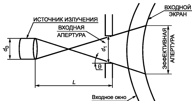
Рисунок 1 — Схема расположения ИСТОЧНИКА ИЗЛУЧЕНИЯ и ВХОДНОЙ АПЕРТУРЫ
