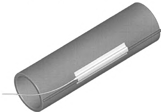
Рисунок 8 — Датчик ограничителя температуры на поверхности электронагревателя
