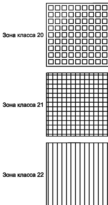
Рисунок 1 — Идентификация зон на чертежах
