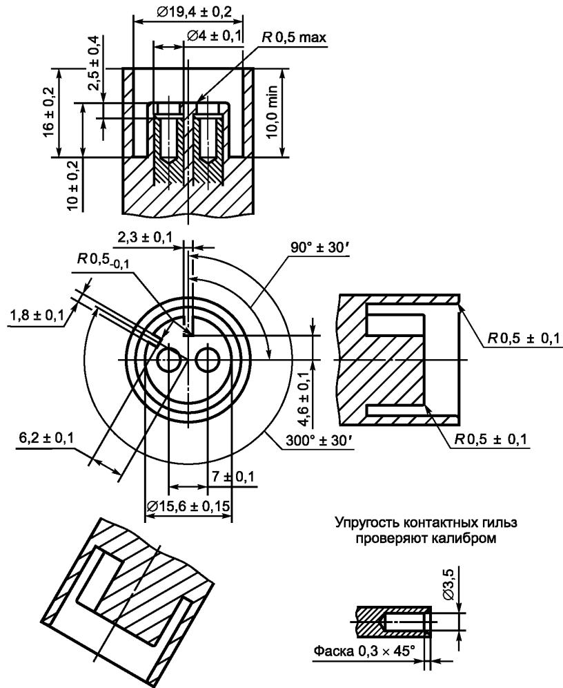
Чертеж предназначен для регламентации только тех размеров, которые указаны на нем.
