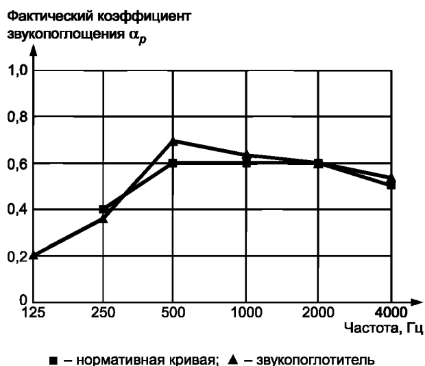
Рисунок А.1 — Пример вычисления индекса звукопоглощения \alpha_w ( \alpha_w = 0,60 )
