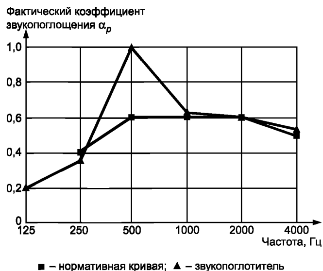
Рисунок А.2 — Пример вычисления индекса звукопоглощения \alpha_w [ \alpha_w = 0,60 (М)]
