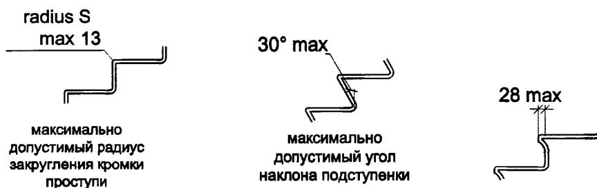
Рисунок 7.23 - Варианты сопряжения подступенки - проступи и габариты ступеней
