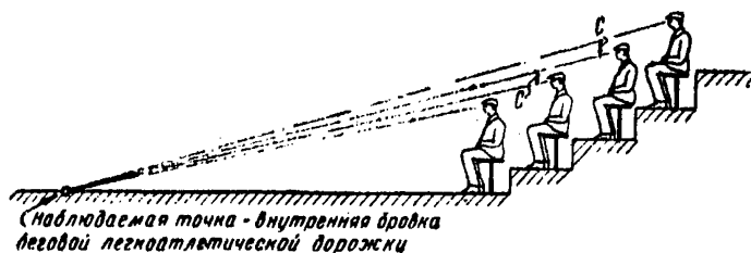
Рис. 3. Графическое изображение величины C C —превышение луча зрения сзади сидящего зрителя над гла- зом впереди сидящего
