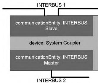
Рисунок 23 — Пример устройства с двумя объектами communicationEntity
