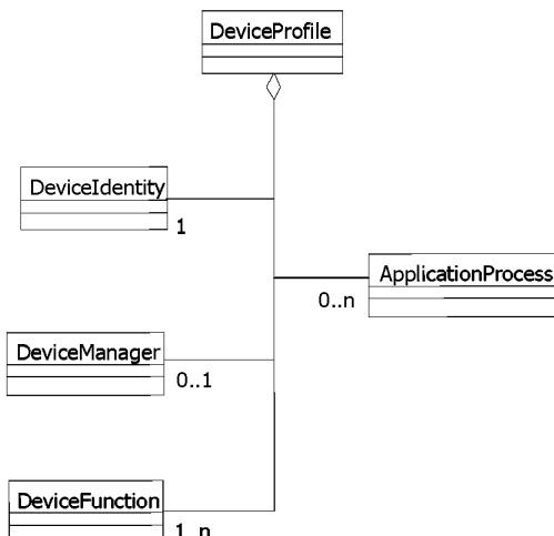
Рисунок 19 – Диаграмма класса профиля устройства INTERBUS
