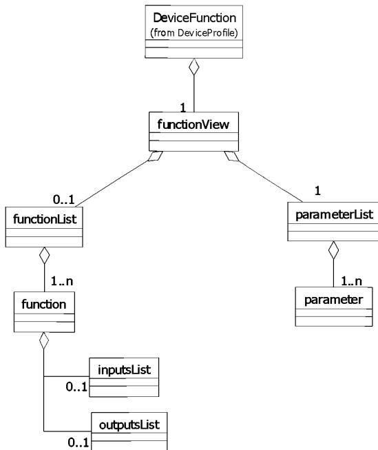
Рисунок 25 — Диаграмма класса DeviceFunction профиля устройства INTERBUS
