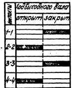
Вентиль У1 Диаграмма работы контактов Механизм электрический У2 Диаграмма работы конечных выключателей
