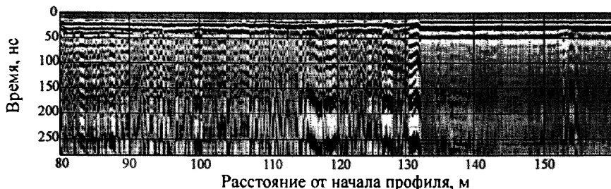
Рисунок В.3 – Пример георадиолокационного (временного) разреза
