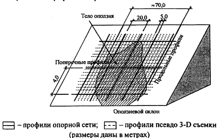
Рисунок В.2 – Схема расположения профилей на оползневом склоне
