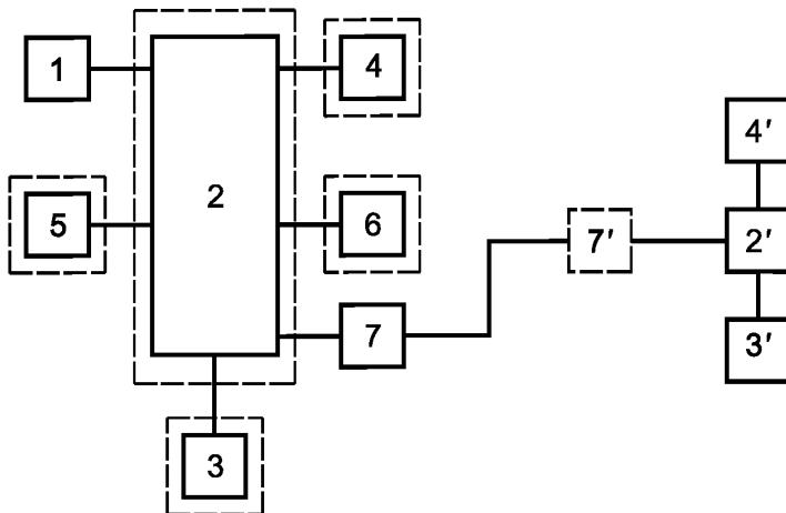
1 — извещатель; 2, 2' — установка управления; 2 — охранный (охранно-пожарный) приемно-контрольный прибор, 2' — пульт централизованного наблюдения; 3, 3' — источник электропитания; 4, 4' — световой и/или звуковой оповещатель; 5 — устройство, управляемое установкой управления; 6 — программируемое входное устройство; 7 — шифрующее устройство; 7, 7' — сигнальный интерфейс, modem; 7, 7' — система передачи извещений
