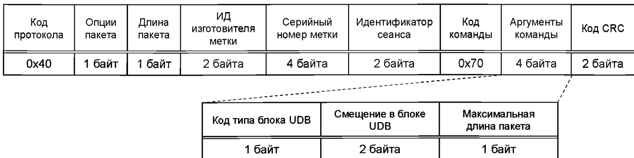
Рисунок 10 — Частная команда УСО конкретной радиочастотной метке для получения оставшейся части данных блока UDB
