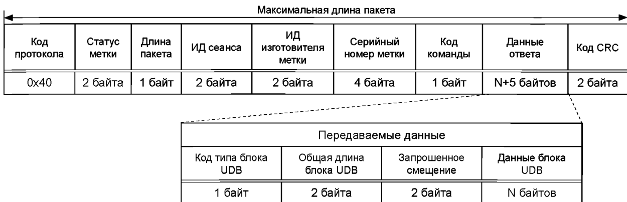
Рисунок 9 — Ответ радиочастотной метки на команду «Collection with UDB»
