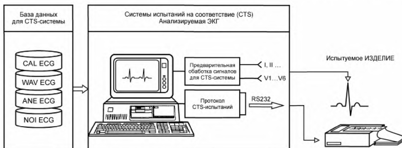
Рисунок II.1 – Система испытаний изделия на соответствие (CTS-система)
