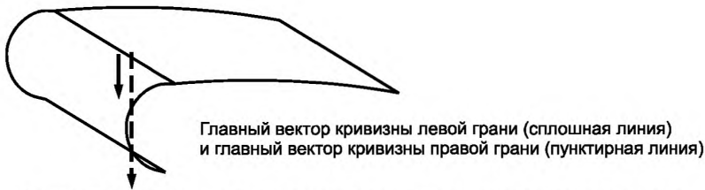
Рисунок 41 — Разрыв G2 вследствие разницы значений вектора кривизны
