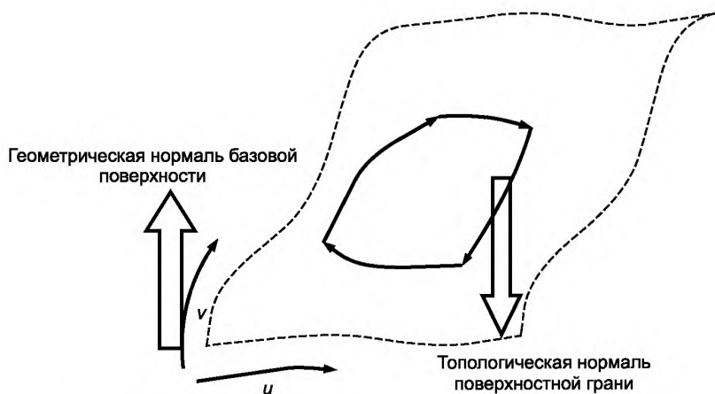
Рисунок 7 — Несогласованные нормали поверхности и грани
