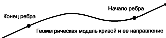
Рисунок 6 — Несогласованные направления ребра и кривой
