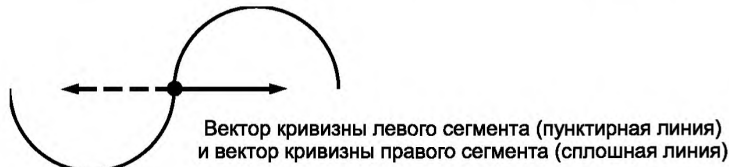
Рисунок 21 — Разрыв G2 вследствие разных направлений радиусов кривизны
