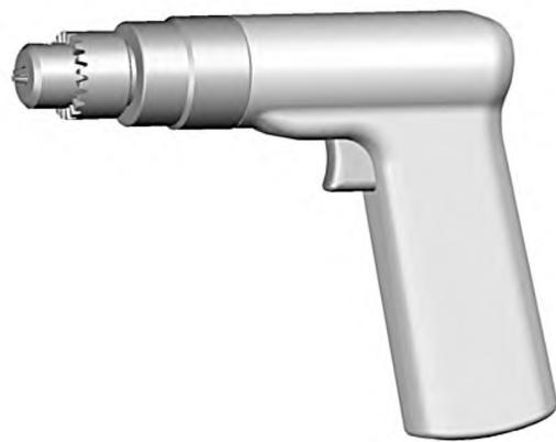
Рисунок 3 — Сверлильная машина с рукояткой пистолетного типа
