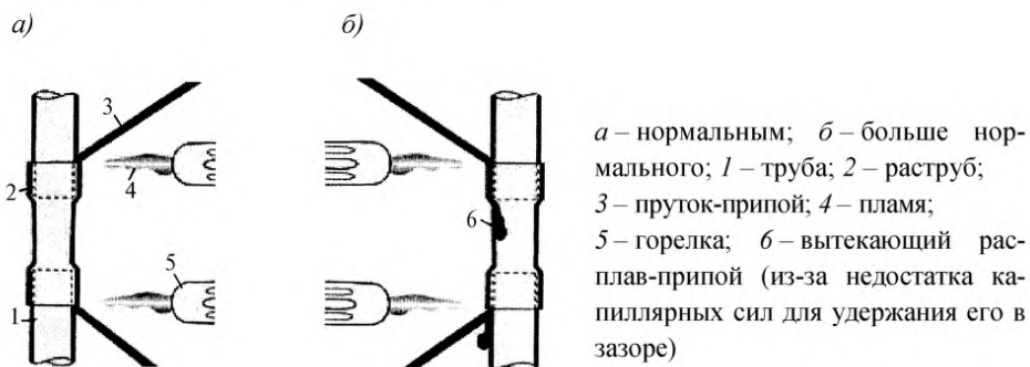
Рисунок 5.6 – Пайка вертикальных трубопроводов из медных труб с зазором
