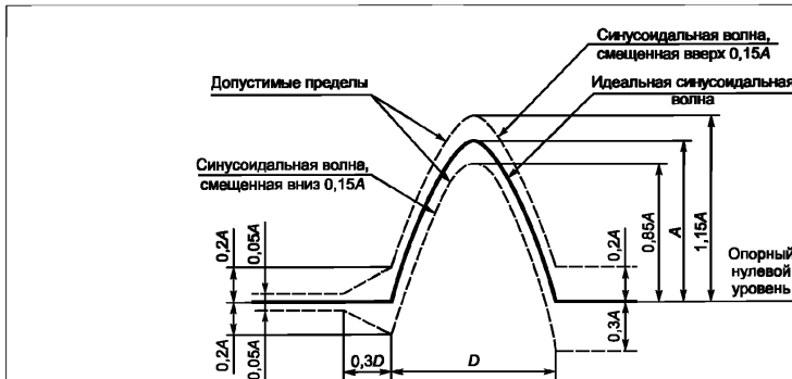
Рисунок 2 – Форма полусинусоидального импульса ускорения и его допустимые пределы
