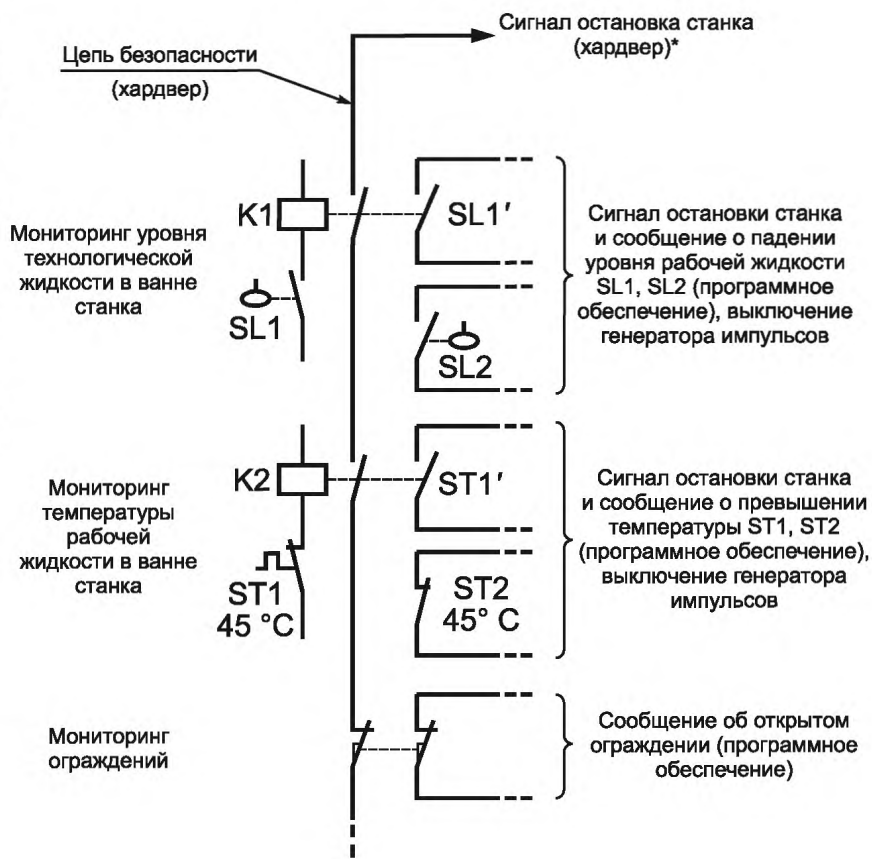
Рисунок А.5 — Пример схематического изображения диаграммы функций безопасности ЭЭ станка
