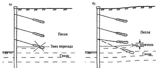
а, б – соответственно недопустимое и допустимое расположение анкеров
