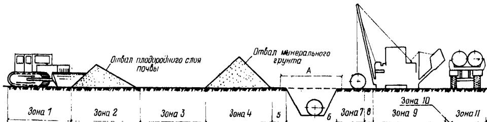
Усредненные параметры полосы отвода при сооружении магистральных трубопроводов
