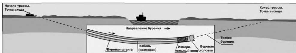
Рисунок 8.3 – Направленное бурение пилотной скважины
