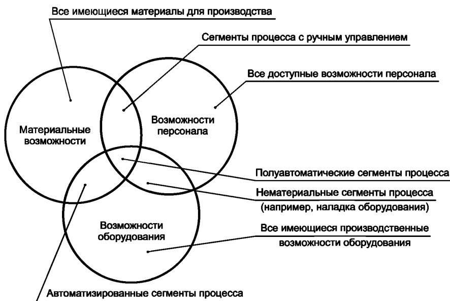
Рисунок 8 — Производственные возможности сегмента технологического процесса
