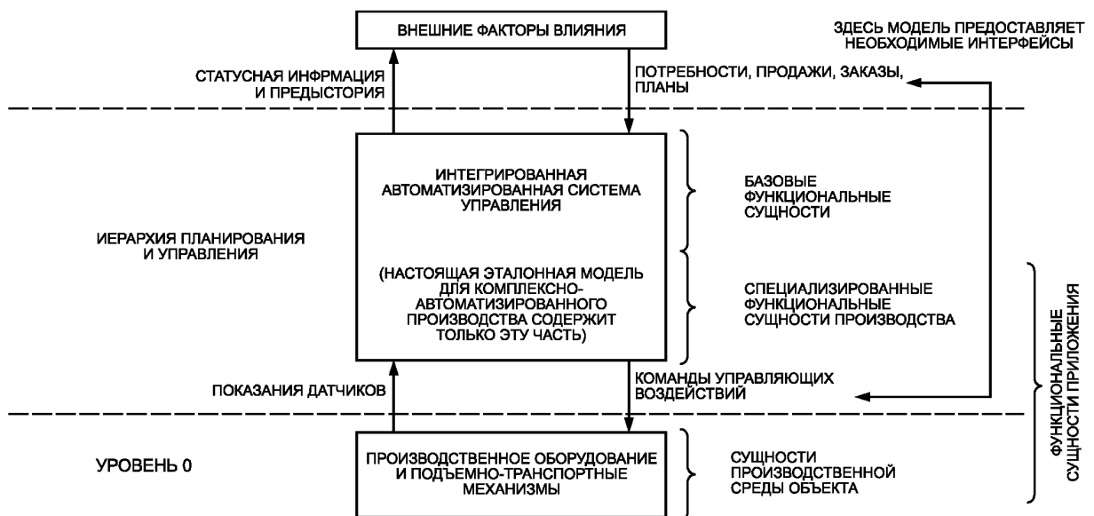
Рисунок D.11 — Связи между несколькими классами функциональных модулей, образующих эталонную модель интегрированной системы управления и структуру автоматизированного производства
