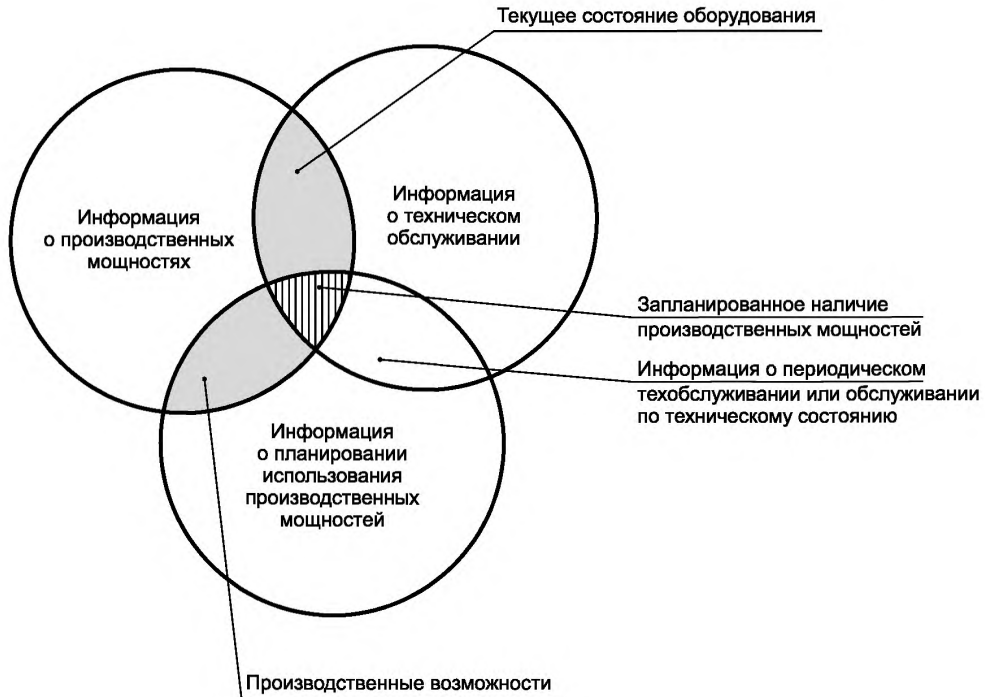
Рисунок 7 — Информация о производственных возможностях
